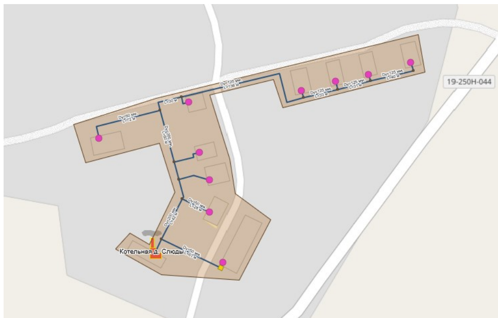
Рисунок 18 – Зона действия источника теплоснабжения д. Слуды
