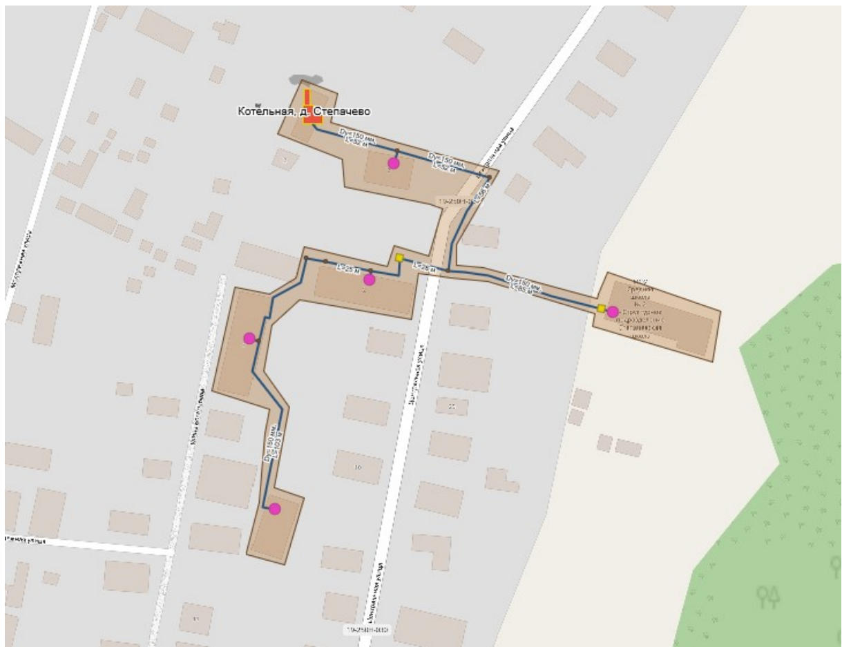
Рисунок 6 – Зона действия источника теплоснабжения д. Степачево
